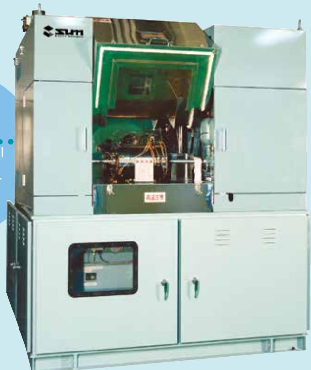
一边旋转汽车盘式制动器的盘侧，一边施加扭矩负荷，评价阻力扭矩特性。
