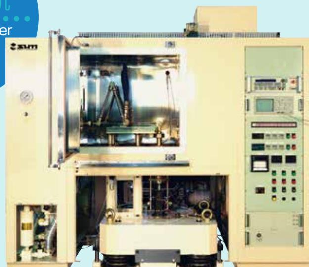
向橡胶套管施加动态扭矩负荷，
