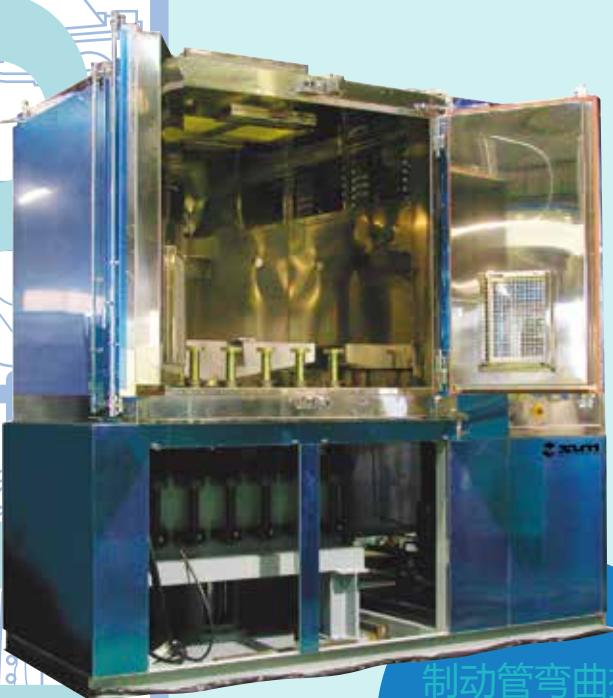
在环境温度下，在矿物油管道内施加冲击压力，评价管道耐久性能的试验装置。
