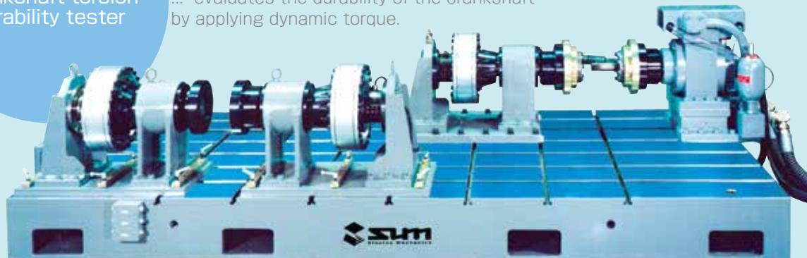
自动测量扭振减震的扭转固有振动数量。
