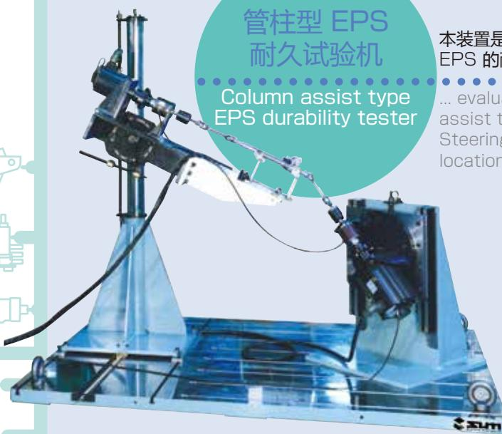
本装置是在实车安装的状态下，评价管柱型 EPS 的耐久试验。
