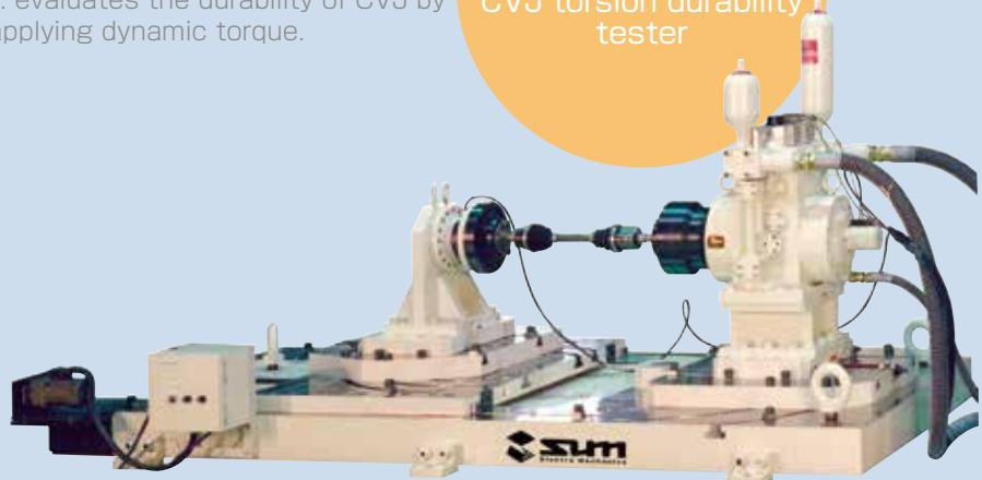
在旋转驱动轴的同时，对轮胎接地点施加动态上下
