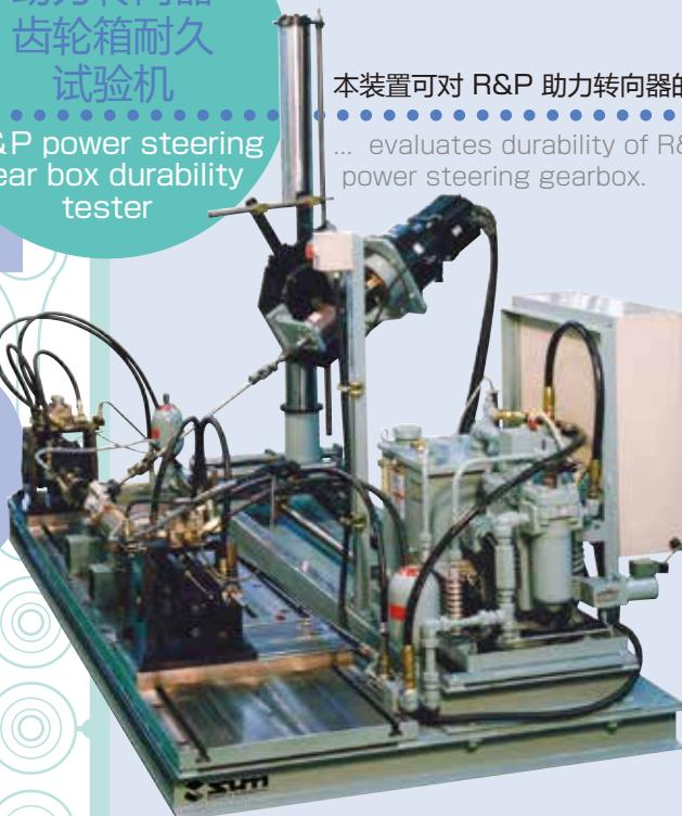
本装置可对 R&P 助力转向器的齿轮箱实施耐久试验。
